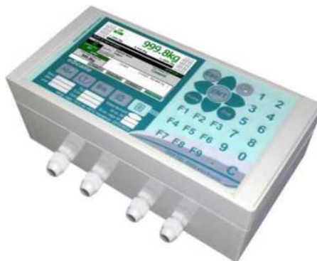
Слика 13. Електронски мерни и показни уређаји тип eScalia (остали изгледи су приказани у припадајућем уверењу о одобрењу типа мерила, табела 2.)
